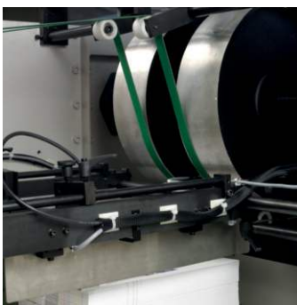
Sheet turnover Salida de las hojas Tambour de retournement Wendetrommel
